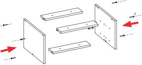
**2.1** Faça a montagem dos montantes fixando as cavilhas préviamente instaladas e parafusando para finalizar a fixação.
